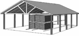
Los perfiles deben ser estibados en sistemas de contención tipo rack. En caso de no contar con dicha estructura metálica, por seguridad, no se debe sobrepasar 1 metro de altura.
