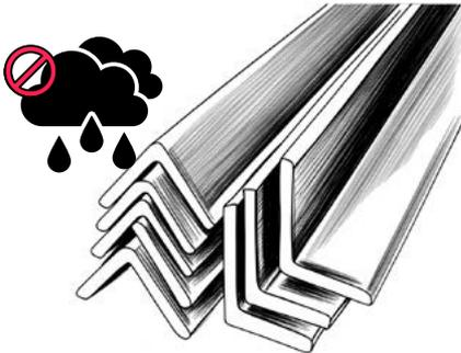
Este tipo de perfiles deben ser estibados en sistemas de contención tipo rack. En caso de no contar con dicha estructura metálica, por seguridad, no se debe sobrepasar 1 metro de altura.
