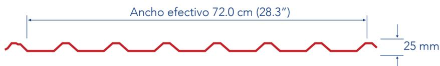
Lámina de acero acanalada con doble canal antisifón para cubiertas de muros en naves industriales; disponible en Pintro. Ideal para usar en naves industriales, donde se requiere resistencia estructural y/o diseñar con pendientes bajas.
