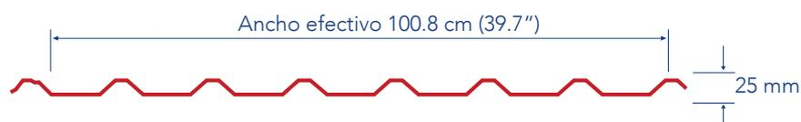
Lámina de acero acanalada con perfil trapezoidal está diseñada para ser utilizada como cubierta defijación expuesta. Disponible en Zintro, Zintro Alum y Pintro. Gracias al poder cubriente de la lámina acanalada R-72, esta es de gran aplicación tanto en techos como en muros, cuenta con canal antisifón y es ideal para cubiertas de naves industriales, bodegas y construcciones en general, donde se requiera una buena capacidad de carga.
