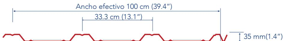
Lámina de perfil ondular de amplia aplicación en cubiertas y fachadas. Disponible en Zintro, ZintroAlum y Pintro. De gran aplicación en la instalación de muros, techos y bardas para la industria de la construcción. Cubiertas con vertientes no mayores a 15 m y pendiente mínima del 10%. Los acanalados ondulados permiten ser combados en construcciones en general y utilizado en techos curvos o semicirculares.
