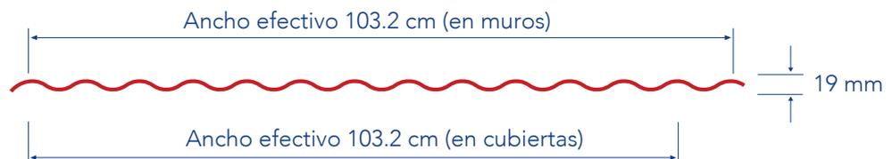
Lámina de gran aplicación en la instalación de muros, techos y bardas para la industria de la construcción. Cubiertas con vertientes no mayores a 15 m y pendiente mínima del 10%. Cubiertas curvas mediante combado previo.
