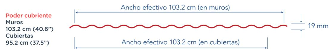
Lámina de gran aplicación en la instalación de muros, techos y bardas para la industria de la construcción. Cubiertas con vertientes no mayores a 15 m y pendiente mínima del 10%. Cubiertas curvas mediante combado previo.
